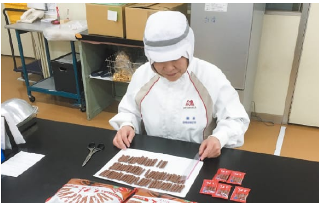
出荷検査（製品の規格に合っているか寸法や重量を測定）
