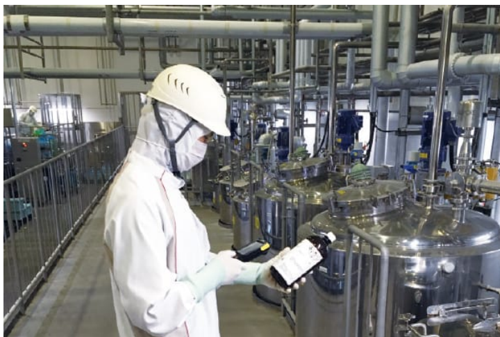
バーコードリーダーでトレーサビリティを確認
